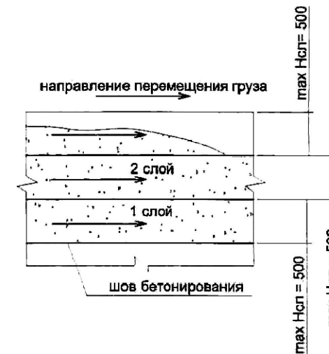
Сур.2. Қабатты бетондау схемасы
